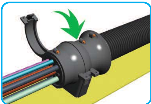
5. Assemble RKS completely with bolts and nuts. RKC를 사용하여 RKS를 그림처럼 고정시킨다.
