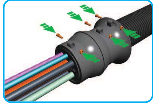
4. Assemble RKS completely with bolts and nuts. RKS를 볼트와 너트를 이용하여 고정시킨다.
